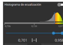
Imagen 4. Histograma e índice GNDVI procesados en Pix4D Fields. Al excluir la reflectancia del suelo, el cultivo de alstroemerias muestra una media de vigor de 0.701 , alcanzando niveles óptimos de 0.958 en las zonas de mayor densidad foliar
